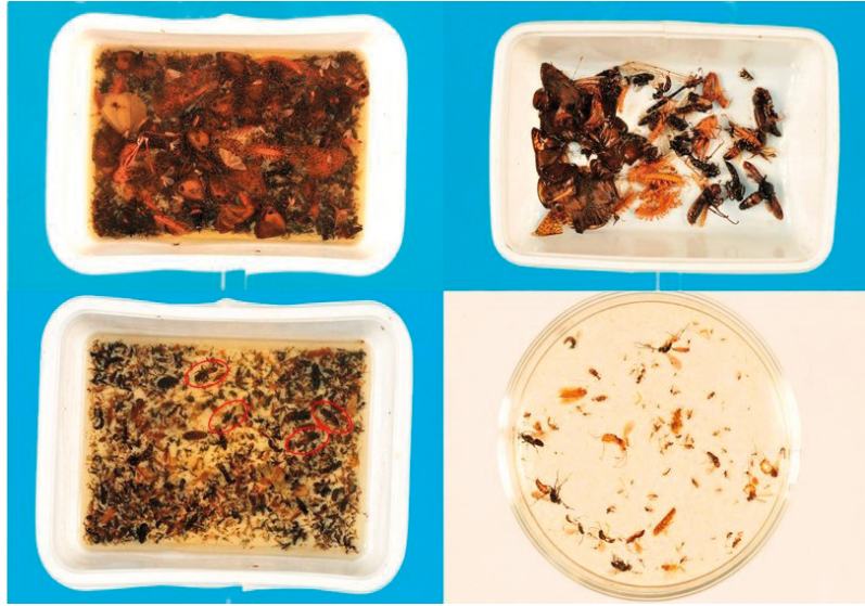
Figura 3 – Step successivi di diluizione del contenuto trap-pole Malaise per l'estrazione de esemplari scelti.
