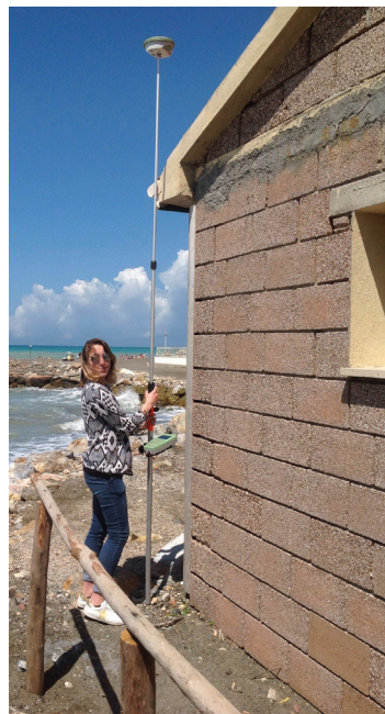
Figura 2. Rilievo del punto di ap- poggio con stazione GPS.
